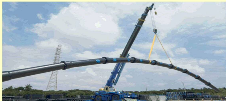
写真5-5 耐震管実験状況 日本ダクタイル鉄管協会
