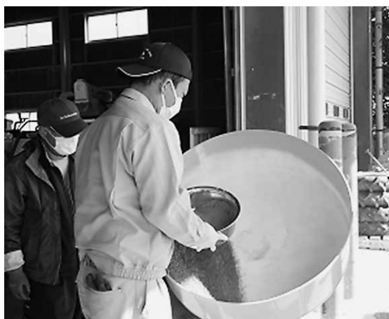
かはん き 攪拌機を使って鉄粉と焼石膏を種にコーティング
