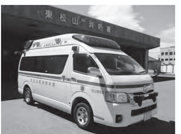
※高規格救急車…救急救命士が行う救命処置に必要な資器材を有し、気管挿管や薬剤投与などの特定行為を実施するスペースが確保された高機能・高性能な救急車。
