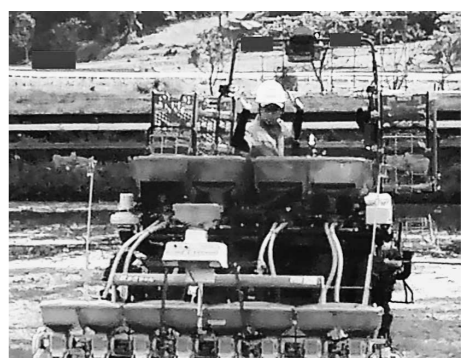
直進キープ機能等により手放しでも直進して作業をします。
