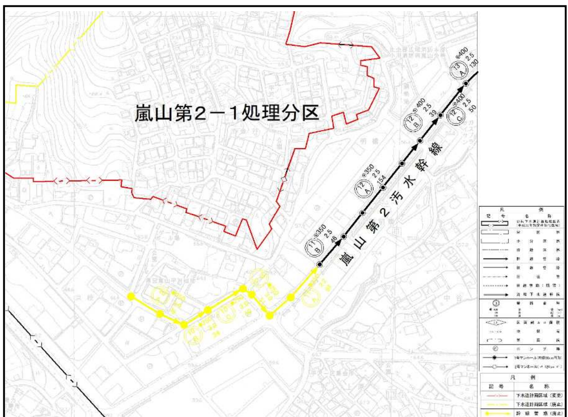
図 8-1 嵐山第2号污水幹線 変更箇所
